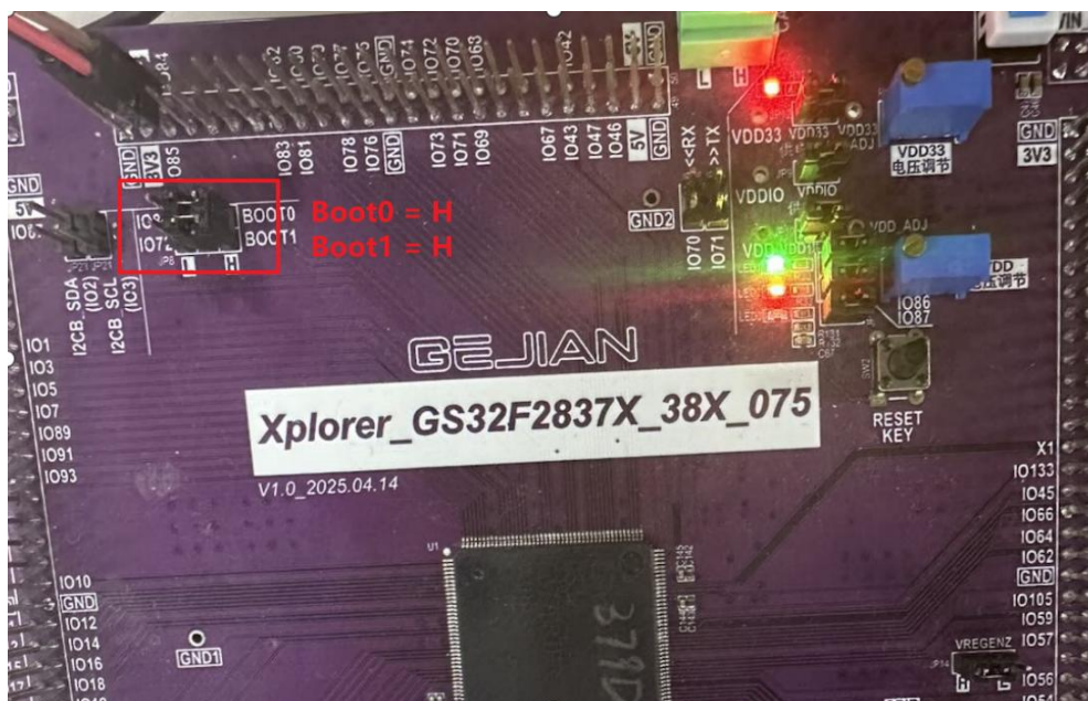
图 4.3-5 开发板或 socket 板 bootpin 跳线配置成 main flash 启动状态
