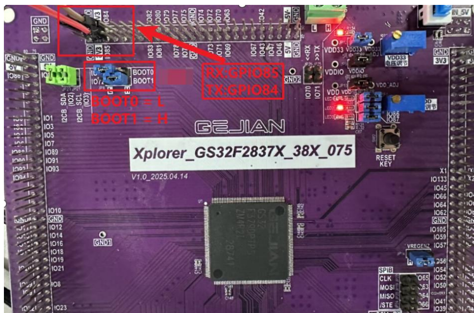
图 4.3-1 开发板或 socket 板 bootpin 跳线配置状态
